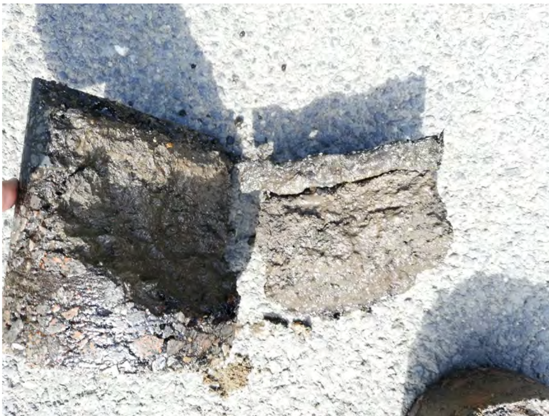
Obr. 8 Odebraný AC vývrt JV4 v rozpadu
