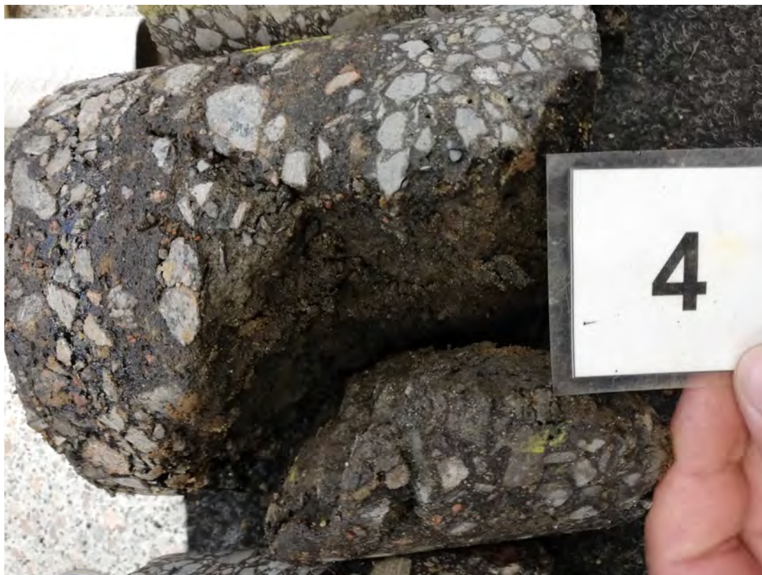
Obr. 17 Pohled na trhlinu AC vývrtu JV4
