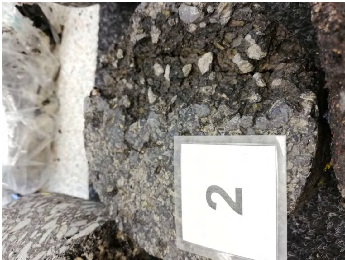
Obr. 14 Pohled na trhlinu AC vývrtu JV2
