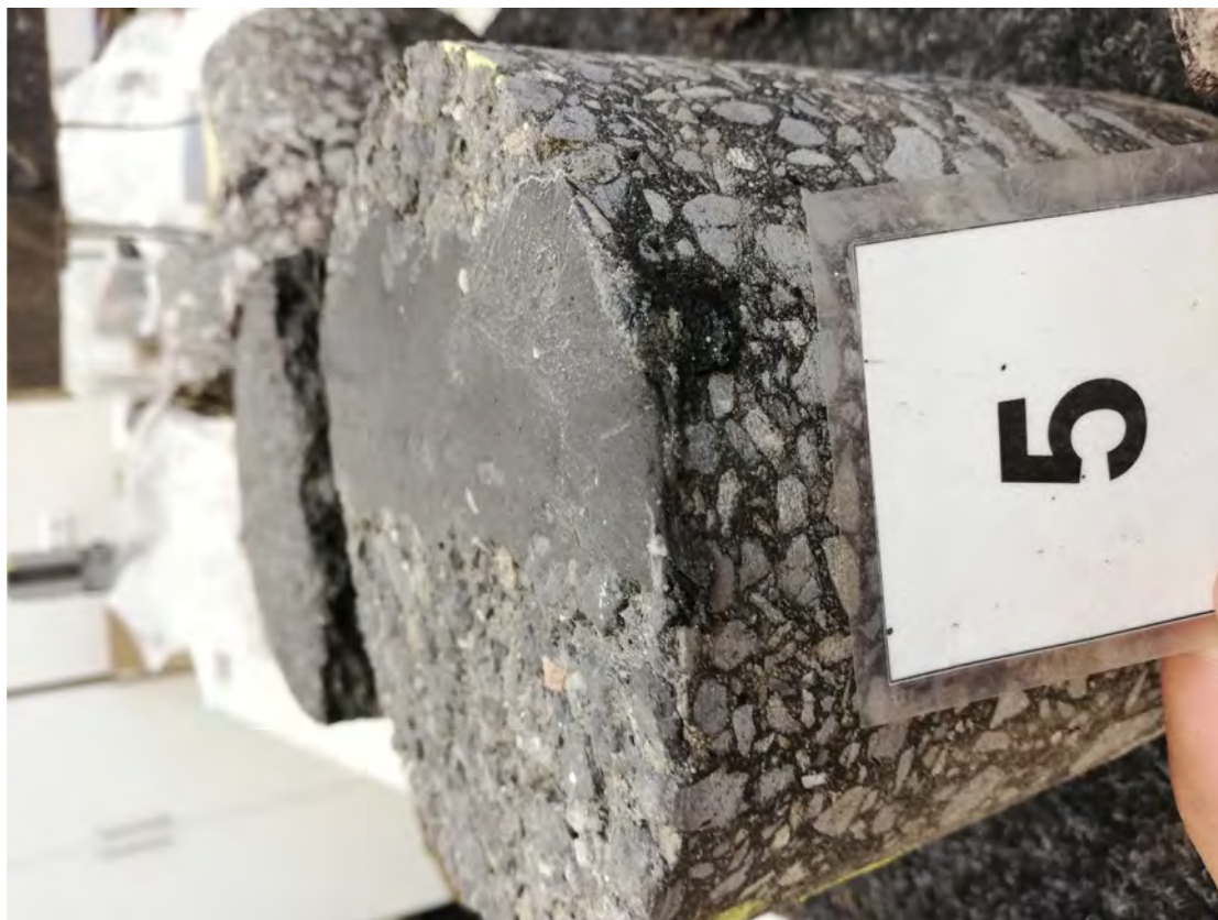
Obr. 20 Pohled na trhlinu AC vývrtu JV5
