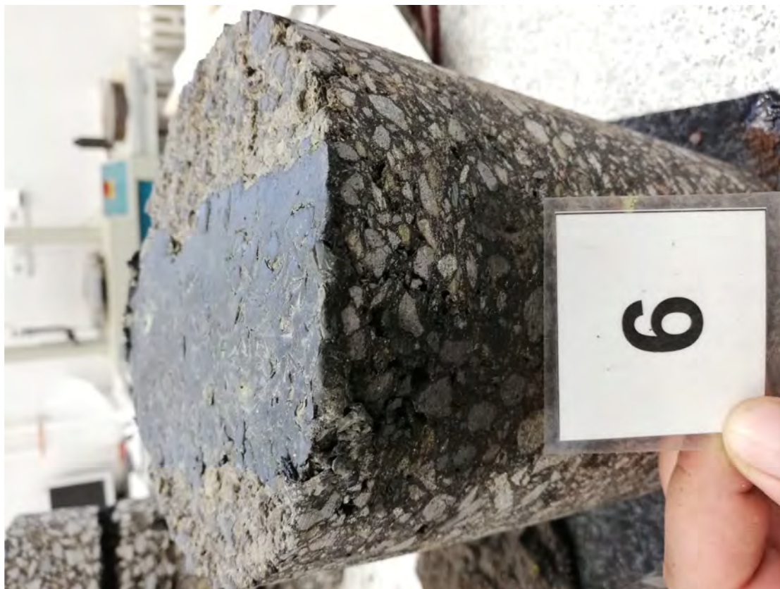
Obr. 22 Pohled na trhlinu AC vývrtu JV6
